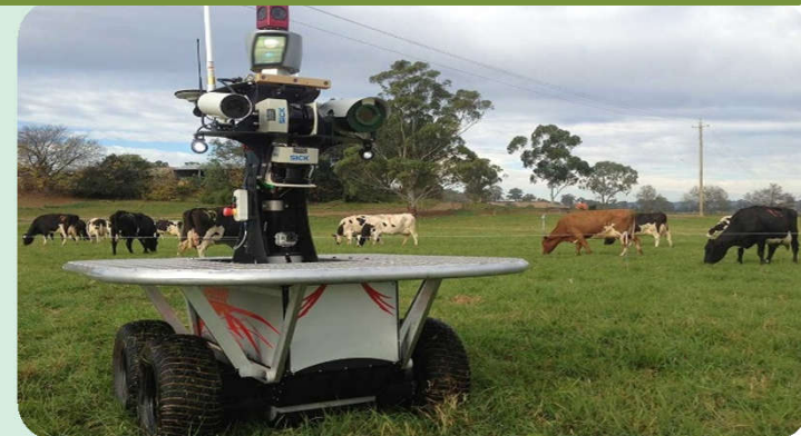
Figure 7 - Робот-пастух Shrimp, который способен заниматься выпасом скота
