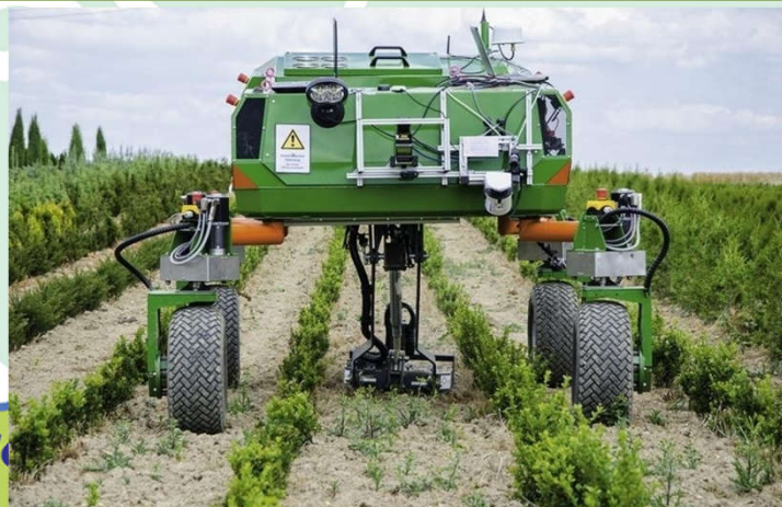
Figure 8 – BOSCH – агроробот, способен измерять влажность почвы, уничтожать сорняки
