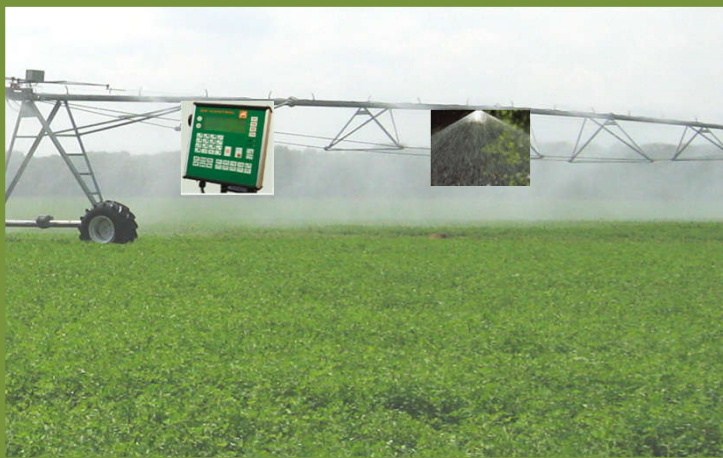
Figure 4 - Определение влажности почвы, N-сенсор для определения азота в растениях, дождеватель регулирует направление струи воды
