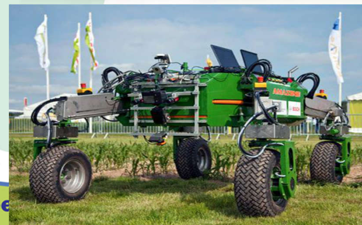
Figure 8 – BOSCH – агроробот, способен измерять влажность почвы, уничтожать сорняки
